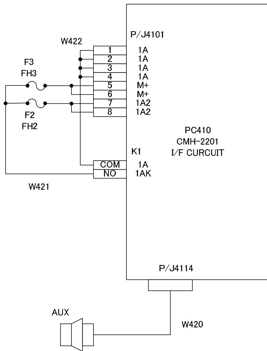
付図 10 NQA-2123 入出力部機内接続図
