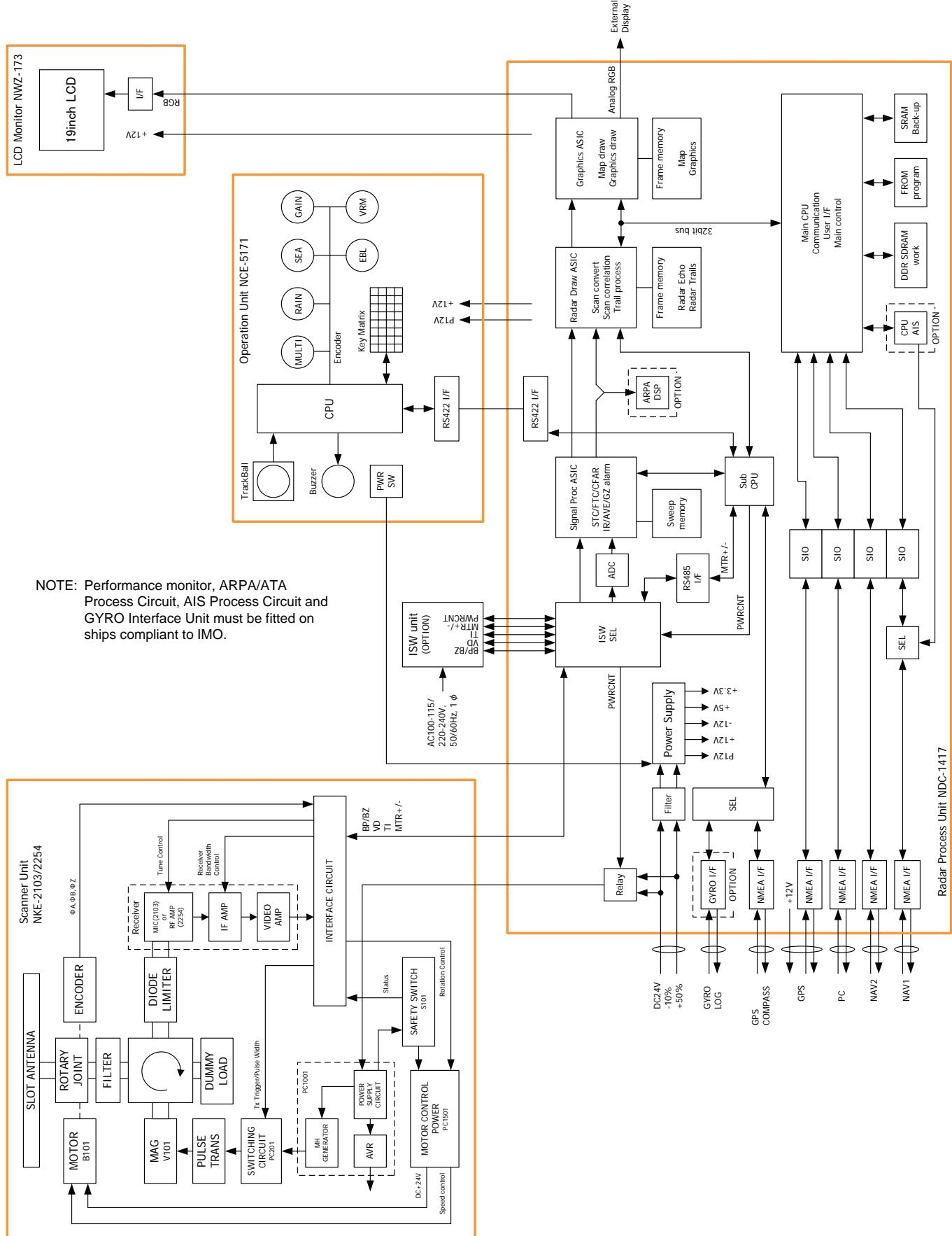
付図1 JMA-5312-6/6HS, JMA-5322-7/9/6HS レーダー装置回路動作説明図
