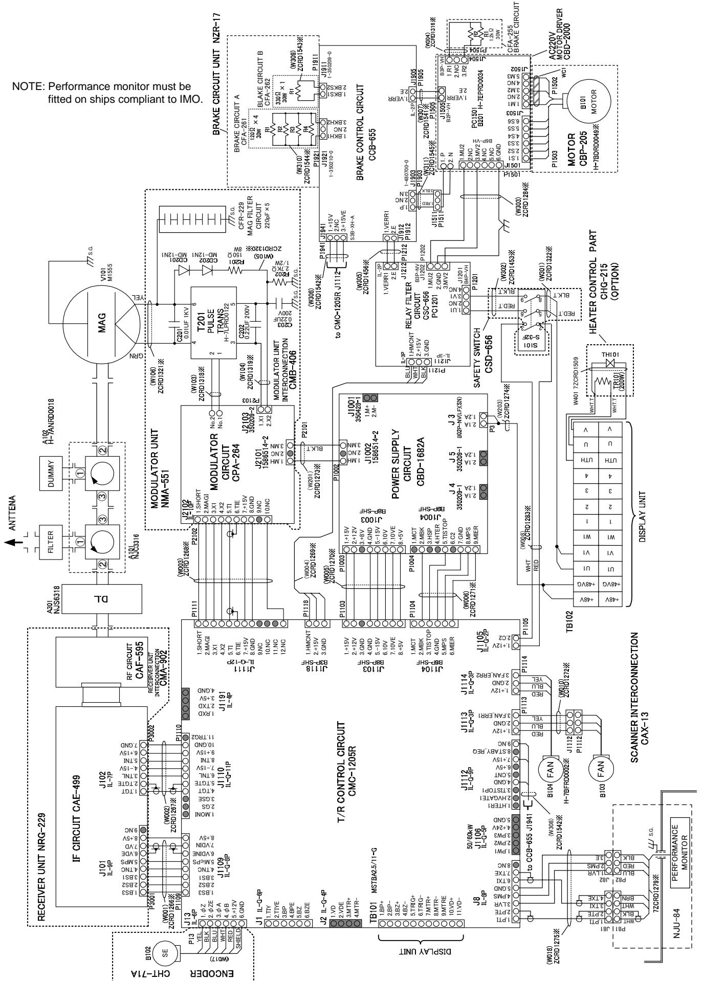
付図 17 NKE-1130 空中線機内接続図 (AC220-240V) (JMA-5332-12)
