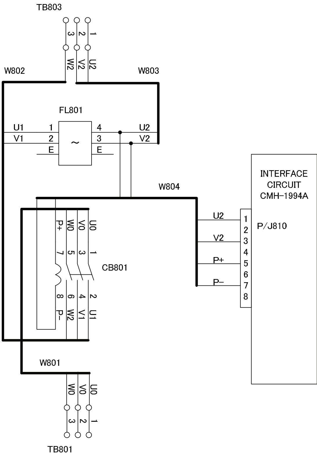
付図 13 NQE-3151A 接続箱機内接続図 (JMA-5332-12)
