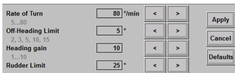
Figure 10.50: The Autopilot parameters
